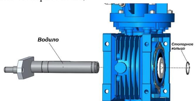
2.4. Снять узел концевиков с редуктора.
