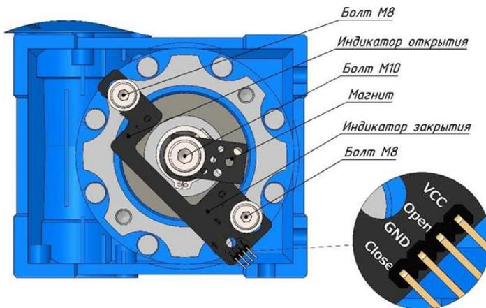
Выключатели выполнены бесконтактными на основе датчиков Холла. Концевые выключатели имеют индикацию: красный – ЗАКРЫТО, зеленый – ОТКРЫТО. Данное положение основания с магнитом соответствуют положению стрелы «открыто», т.е. вертикальному, индикатор зеленый. Для регулировки положения
