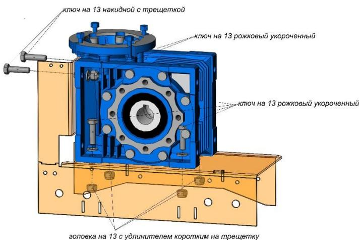
2.3. Вынуть из редуктора водило, для чего снять стопорное кольцо
